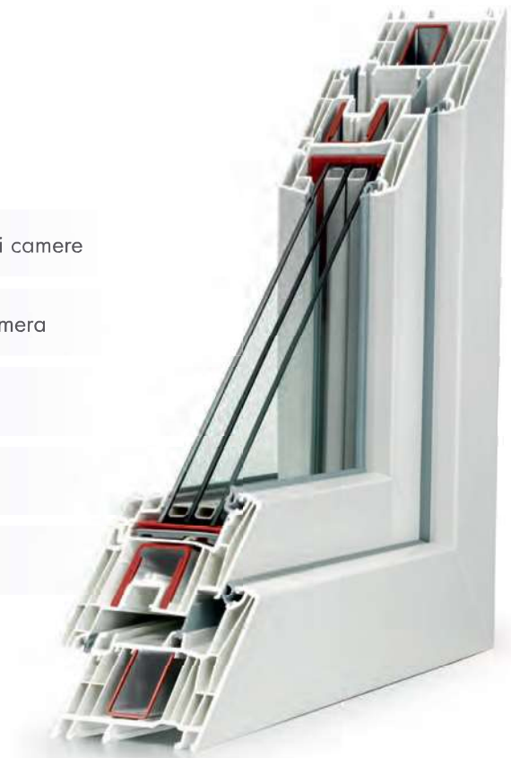
Esempio di finestra PVC 80 con vetrocamera doppia standard: 4/16/4/14/4.
